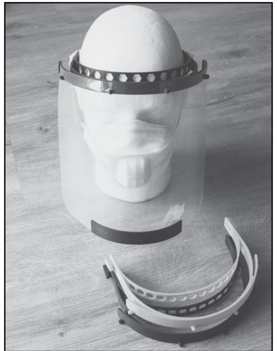
**Ein fertig montiertes Faceshield, davor einzelne Teile aus dem 3D-Drucker**
